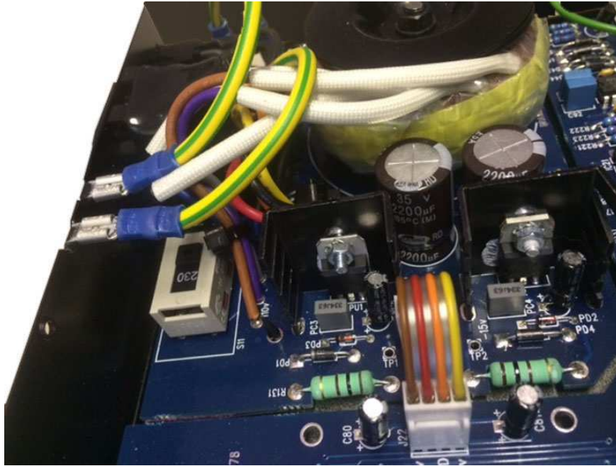
Voltage Selector Switch 位置
